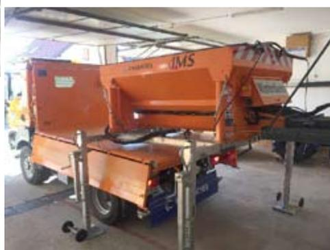
Doppelkammersystem 1/3-2/3, aufgesetzt auf der Ladefläche des LKWs und mit Spannkettensystem verzurrt. Eine problemlose Montage und Demontage ist in ca. 15 Minuten erledigt.
